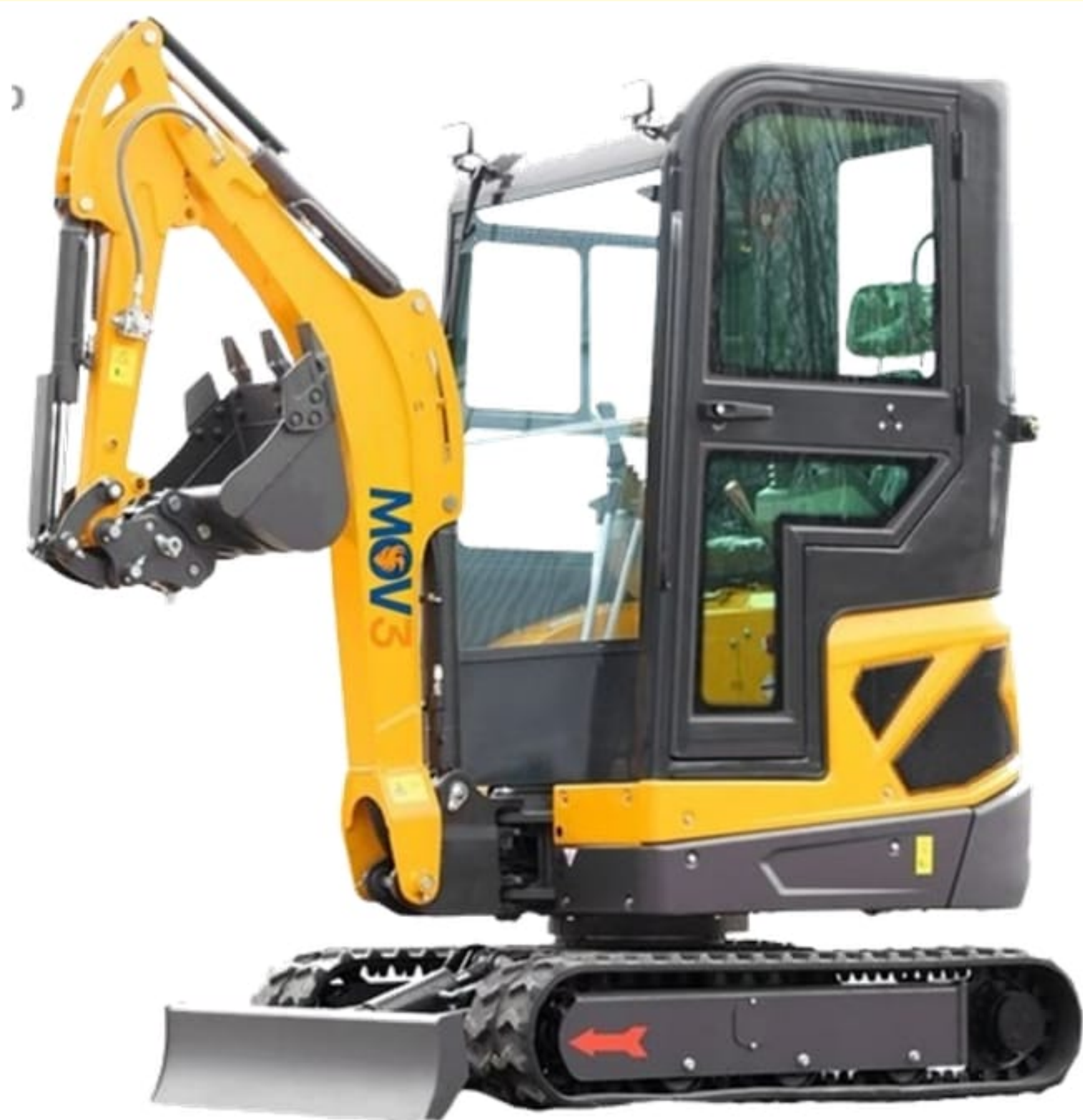
MINIESCAVATORE 18 Q.LI - 1800 KG - CINGOLI GOMMA - KUBOTA
