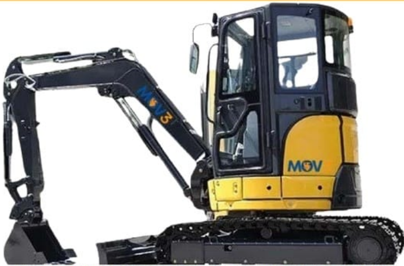
MINIESCAVATORE 40 Q.LI - 4000 KG - CINGOLI ACCIAIO - YANMAR
